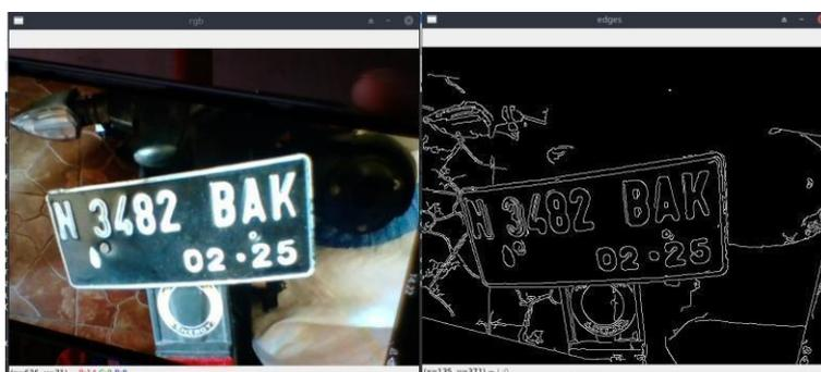
Gambar 3.29 Rancangan Tampilan Sistem Deteksi Tepi pada CCTV
